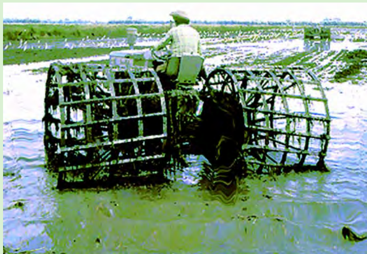
Figura VIII-1. Tractor con ruedas de hierro o «cestas».
