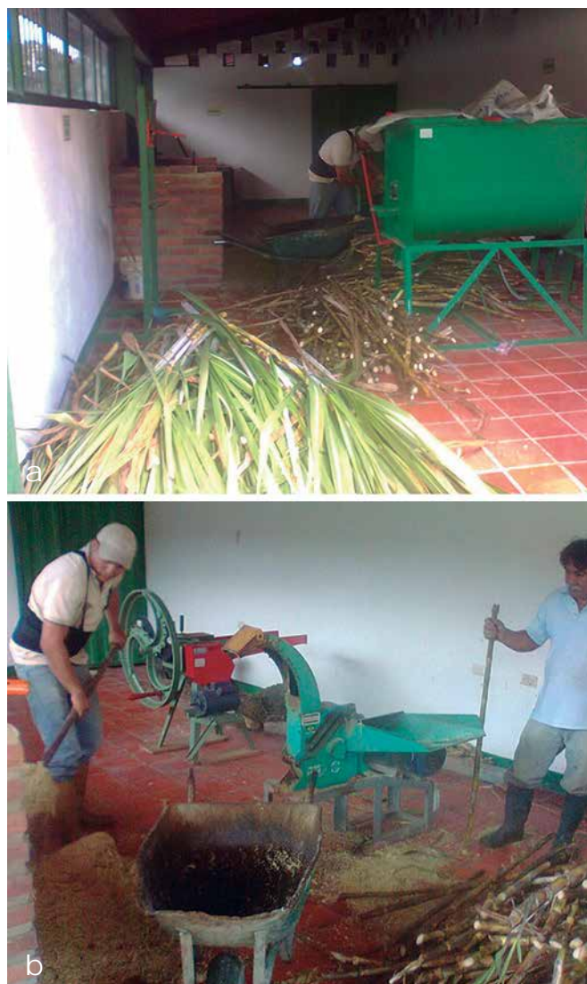
Foto 4. a) Apronte de la materia prima; b) repicado de caña en picadora de alta revolución.
