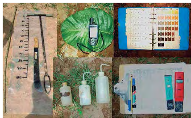
Foto 3. Distintos equipos usados en la evaluación de tierras. De izquierda a derecha: cinta métrica, machete, barreno, GPS, tabla Munsell, picetas, pHmetro y conductímetro de campo.
