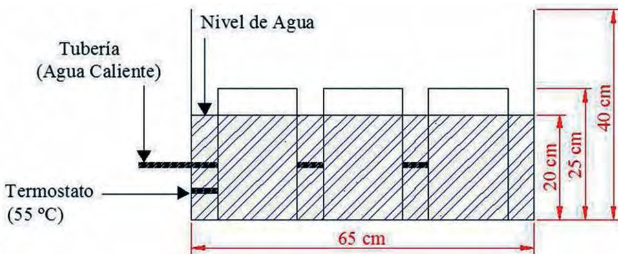
Figura 1. Vista lateral del módulo de compostaje en donde se muestran los recipientes de vidrio y las dimensiones del módulo.
