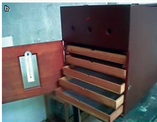
Foto 6 a y b. Incubadora artesanal mostrando sus seis bandejas y termómetro.
