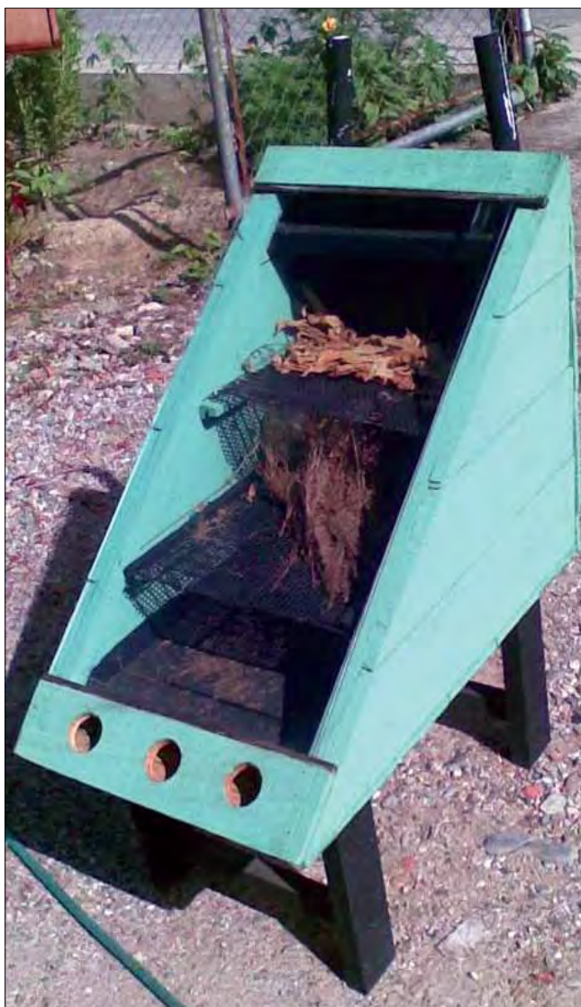
Figura 4. Desecador solar artesanal.
