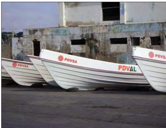
**Figura 6. Peñeros de fibra de vidrio con motores fuera de borda de 48 Hp.**
