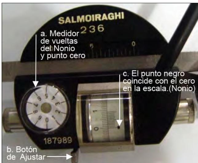
Figura 3. Equipo medidor y ajustador del planímetro.
