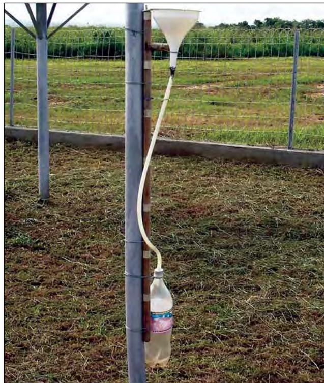
Figura 2. Pluviómetro ensamblado
