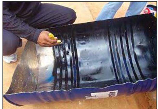
**Figura 2. Interior del tambor oscuro para facilitar la absorción de calor**
