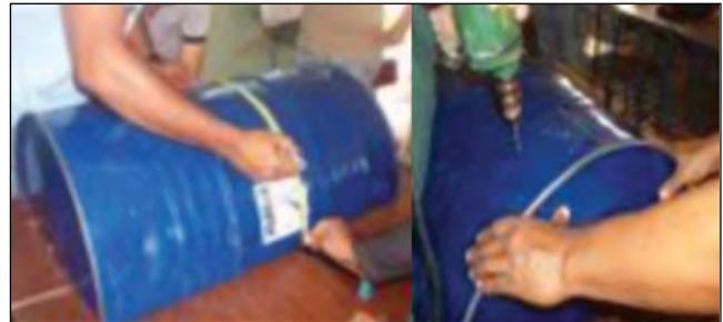
**Figura 1. Corte y perforación del tambor de 200 litros**
