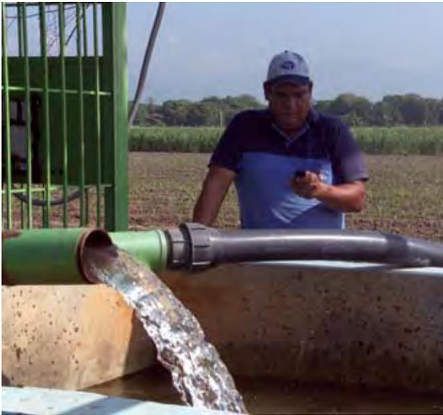
Figura 1. Aforo volumétrico, tiempo medido con el cronómetro del teléfono celular.
