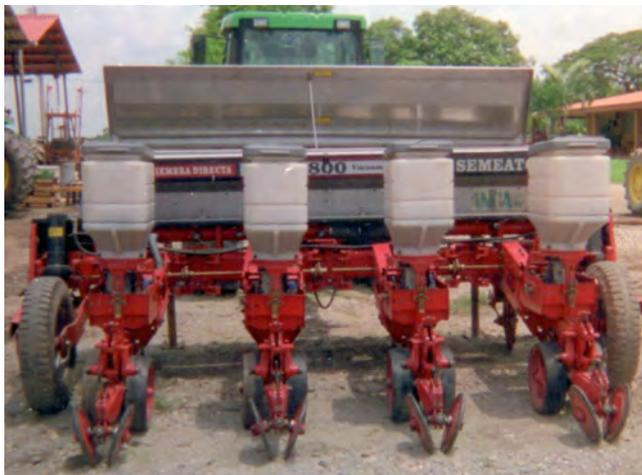
Figura 1. Sembradora para siembra directa de cuatro hileras.
