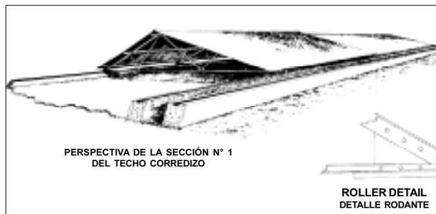
Figura 1. Techo corredizo para piso de cemento.
