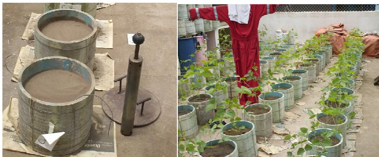
**Figura 1. Cilindros, martillo Proctor, soporte de golpes y medidores de humedad utilizados en el estudio.**
