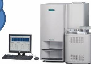
Det. Nitrógeno *Kjeldahl*
