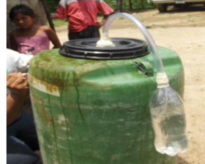
8. Sumergir la otra punta de la manguera en una botella plástica con agua para que no se devuelvan los gases
